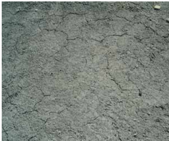
Figure 2 - Les cycles d'humectation-dessèchement des marnes bleues produisent une abondance de petits éléments sans cohésion qui sont facilement mobilisés par les fortes pluies (largeur de l'image : 50 cm). The repeated hydration-desiccation cycles in blue marls produce an abundance of non-cohesive small elements that are easily eroded by intense rainfalls (width of the image : 50 cm).
